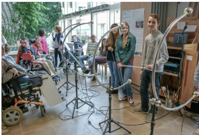
Le BAO-PAO : dispositif permettant d'interpréter de la musique assistée par ordinateur à partir de capteurs adaptés aux capacités spécifiques de chacun.
